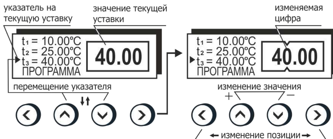
Рисунок 6 — Изменение значения уставки температуры
